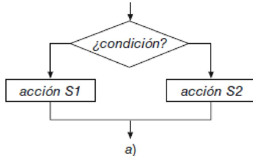
La estructura anterior es muy limitada y normalmente se necesitará una estructura que permita elegir entre dos opciones o alternativas posibles, en función del cumplimiento o no de una determinada condición. Si la condición C es verdadera, se ejecuta la acción S1 y, si es falsa, se ejecuta la acción S2
